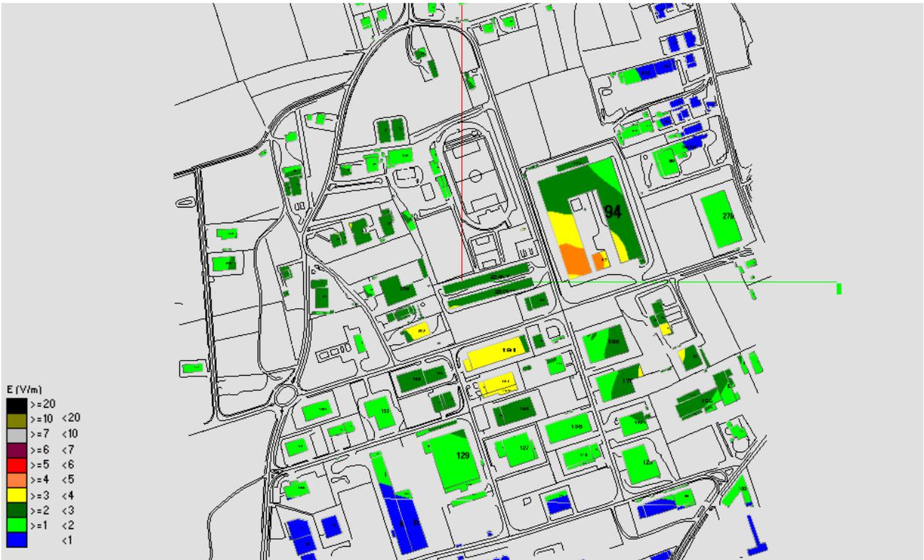
Fig. 2 Impatto Elettromagnetico – zona Via Tonutti Via Comelli – Vista dall'alto
