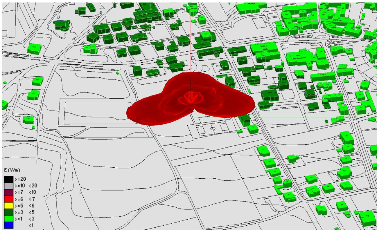
Fig. 7 Impatto Elettromagnetico – zona Via Schiratti – 0° N
